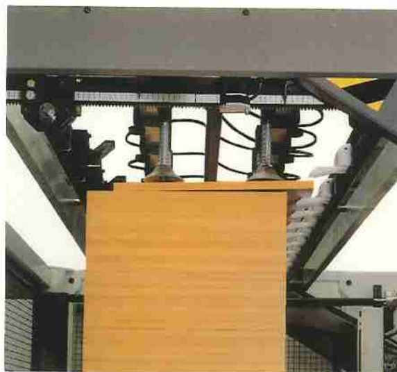
Dispositivo meccanico di distacco pannelli Mechanical separation device
