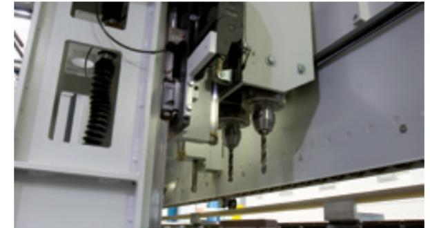
Mitfahrendes, vertikales NC-Bohraggregat
