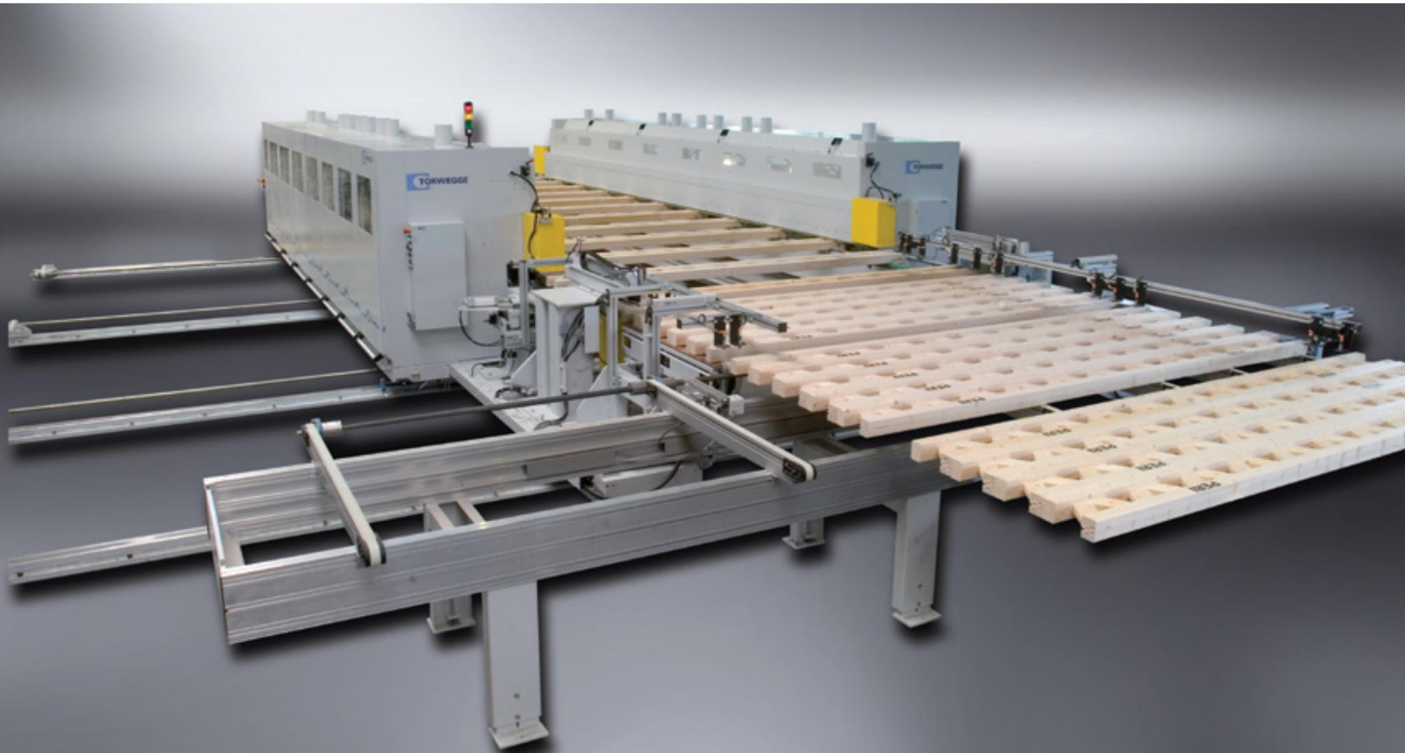
Individuell nach Kundenwunsch und Material werden die Werkstückgrößen festgelegt. Hierbei sind Arbeitsbreiten von 6.000 mm und mehr keine Seltenheit und können problemlos realisiert werden. Automatisierte NC-gesteuerte Werkstückzuführungen und Vereinzelungen sowie Roboterlösungen gehören zum kundenbezogenen Lieferprogramm.
