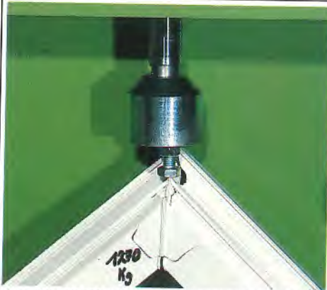
Bruch der Ecke und gutes Bruchbild nach einer Belastung von 1270 kg (ohne WG 1). Clearly visible breakage of corner resulting from a load of 1270 kg. Rupture d'un angle présentant une bonne ligne de rupture après un effort de 1270 kg.
