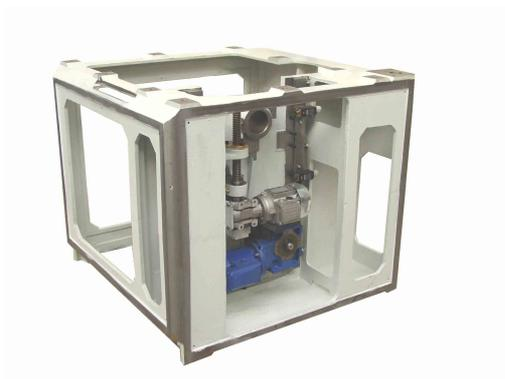
**1. BÂTI MONOBLOC FONTE** avec larges faces d'assises des tables et paroi de guidage du chariot à queues d'aronde pour le mouvement vertical.
