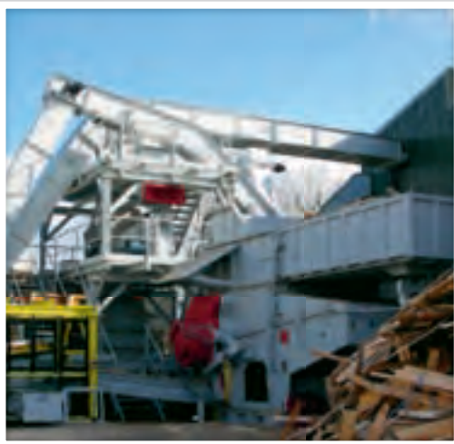
Beispiel: Ein-Wellen-Zerkleinerer (VAZ)
