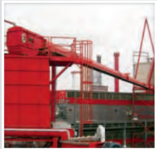
Beispiel: Rohrgurttörderer (VecoBelt)
