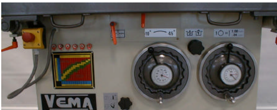
Mechanische Höhen- und Schwenkverstellung des Fräsdornes über Handräder mit integrierten Anzeigen
