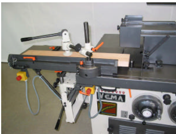
Zapfenschneid- tisch in Arbeitsposition Mit Schlitzhaube und Tiefenanschlag
