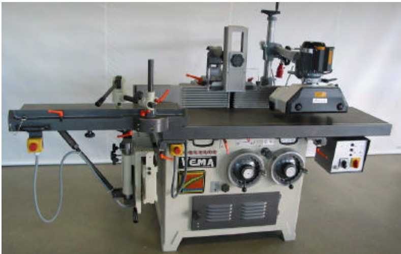
Type TFMSR2-4 mit Zapfenschneid- tisch; Vorschubgerät; AIGNER –An- schlagbacken und Schalterkasten unter dem Maschinentisch
