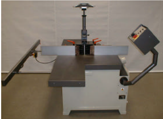
Type TFMS2-4 mit ausziehbarer Rahmenauflage und Fräsanschlag drehbar um 360° mit Tischring sowie wegschwenkbarem Schaltpult
