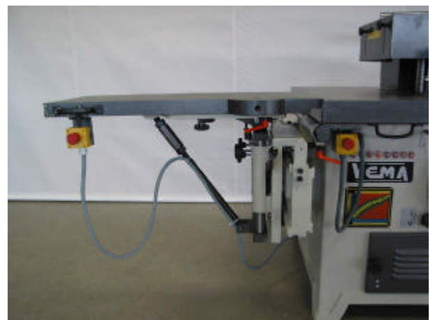
Zapfenschneid- tisch als Tischver- längerung abgesenkt auf Maschinen-tischhöhe
