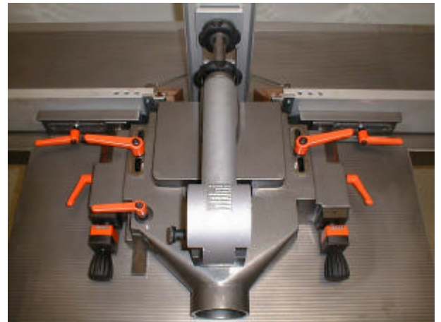
Fräsanschlag mit Zentralverstellung und Einzelverstellung der Anschlag- backen ablesbar über Digitalanzeige Genauigkeit 1/10mm
