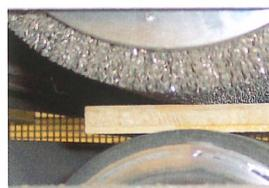
**WIRKSAM:** Der Einsatz dieses Aggregates ermöglicht ganz besondere Oberflächenbearbeitungen. Die spezielle Strukturbürste strukturiert Möbelteile, harte und weiche Hölzer, Fußböden oder Antiklook bis zu einer Strukturtiefe von 1 mm und einem Durchlauf von 10 m/min.
