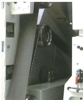
**QUERSCHLEIFAGGREGAT:** Das Querband mit Schlefkissen optimiert die Oberflächenqualität. Ein nachfolgender Fertigschliff mit dem Breitband übernimmt das Abschleifen der kurzen Fasern. Sogar der Endschliff von Lackflächen ist bei diesen gleichmäßigen Ergebnissen möglich.
