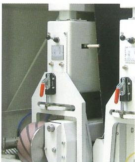
**LÄNGSSCHLEIFAGGREGAT:** Der gleichmäßige Schleifdruck auf Kanten und Flächen basiert auf den mit der Schleiflamelle fest verbundenen Druckstücken. Zur Vermeidung von Oszillationsspuren kann ein quer laufendes Drucklamellenband eingesetzt werden.
