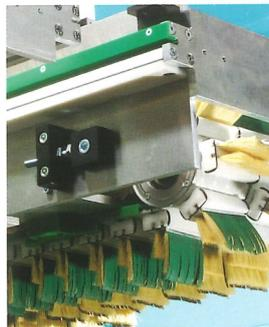
**FLEXIBEL:** Der schnelle Austausch von Querbürstaggregate durch ein Rundbürstaggregate innerhalb nur weniger Minuten erzielt hohen Bedienkomfort. Die optionale stufenlose Schrägstellung der Rundbürsten gewährleistet eine perfekte Kantenbearbeitung.
