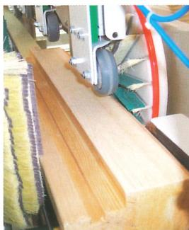
**TELLERBÜRSTAGGREGAT:** Insbesondere für die Bearbeitung von Längsprofilen eignet sich der Einsatz von Tellerbürsten. Hierdurch bietet sich die optimale Möglichkeit, die Höhendifferenz der Holzstruktur zu verringern. Daraus resultiert eine homogene Lackoberfläche.
