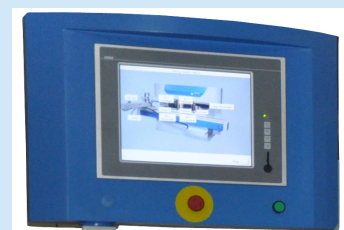
Ecran tactile 15" couleur avec console de commande
