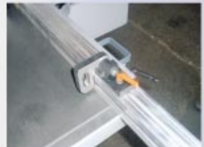
Maßeinstellung über Linal mit stabilem wegklappbaren Anschlag
