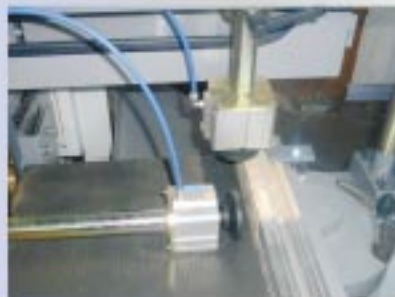
Vertikale und horizontale Werkstückspannung erfolgt über pneumatische Klemmzylinder.
