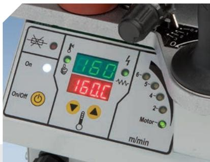
Temperaturregelung (120 bis 200° C) gesteuert durch Mikroprozessor für größere Genauigkeit.
