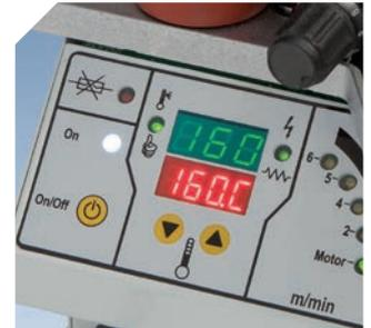
Temperatureinstellung (120° - 200°C) wird von einem Mikroprozessor für hohe Exaktheit und Genauigkeit überwacht. Die Temperatur steigt durch Stromimpulse damit das Heizelement geschützt bleibt, und so die Lebensdauer erhöht wird.
