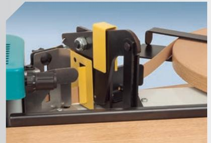
Modell PEB250TA mit automatischem Bandschnitt an der Rückseite. Fußpedal für gekrümmte oder anderweitig geformte Werkstücke.
