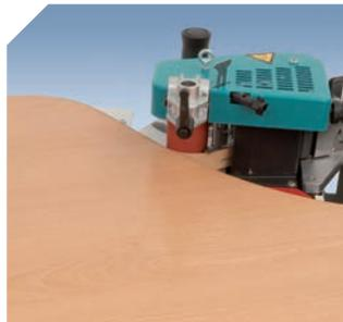
Einfaches Anleimen von geformten und abgerundeten Platten.
