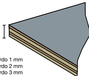
Spessore pannello 16-50 mm con spessore bordo 1 mm
