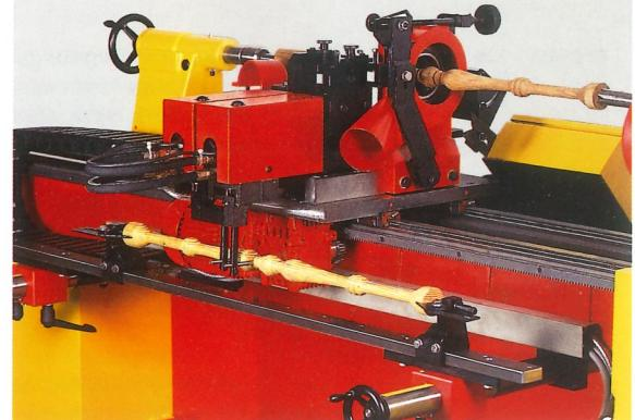
Maschinenrückseite mit zweifachem Abtastsystem, Kugelbahnhörführung auf dem Bankbett, Vorschubmotor, Energieführungsstange, Schablonenträger mit Originalmuster-Abtastung und Verstellmechanismus
