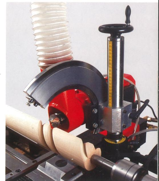
Fräsaggregat mit horizontal eingestelltem Fräskopf
