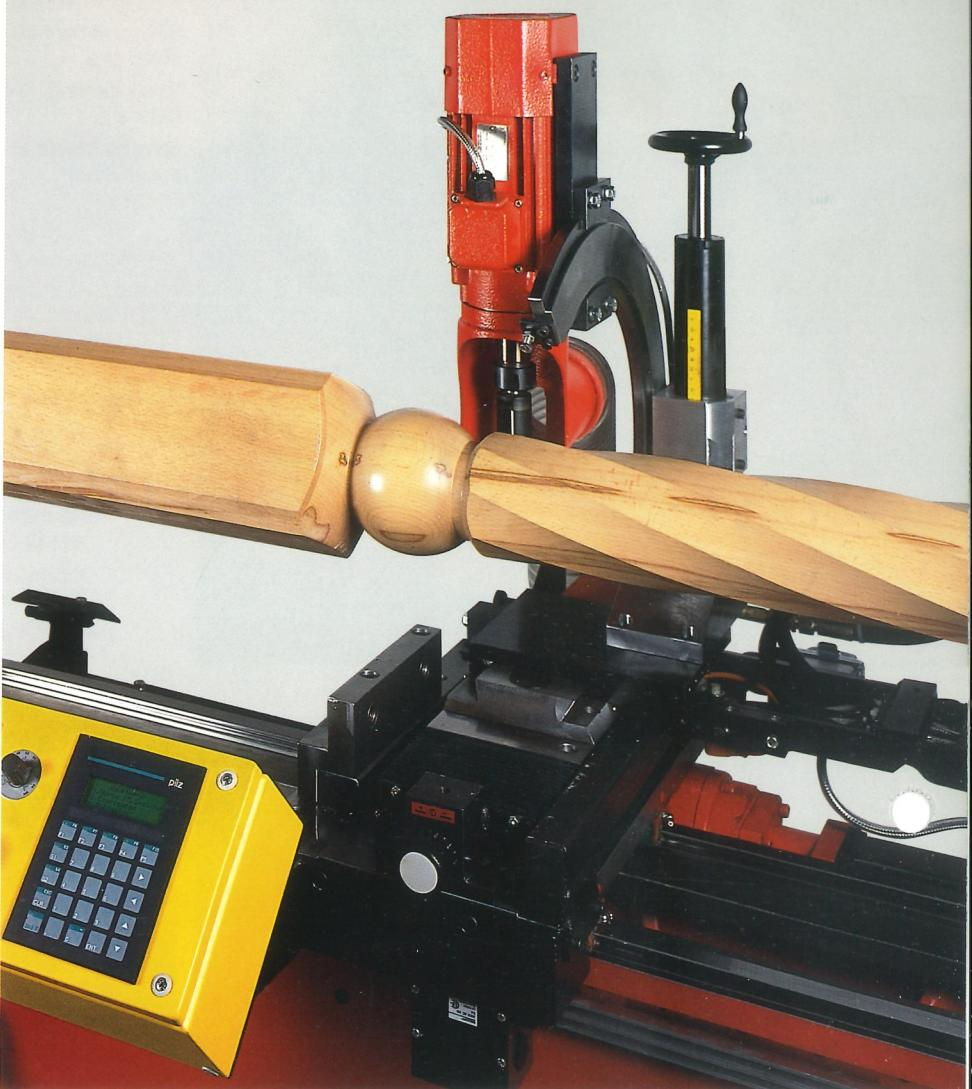
Frässaggregat mit horizontal eingestelltem Fräskopf
