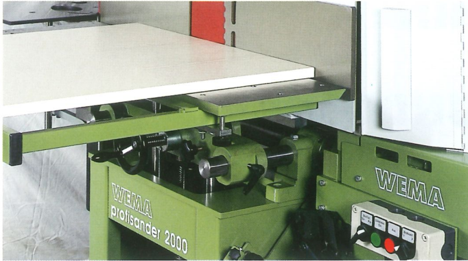
Tischverbreiterung für große Werkstücke / Table extension for large workpieces
