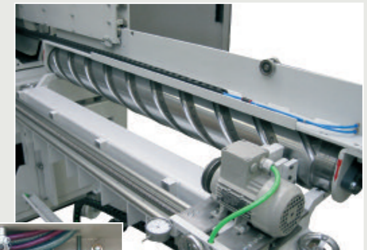
Hobelwelle mit servicefreundlichem Zugang und Schärfvorrichtung
