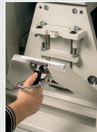
Robuste Tragbalkenverriegelung mit Einhandbedienung
