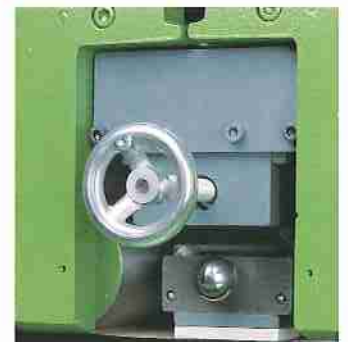
Die Höhenverstellung erfolgt zentral über Spindel und Schneckenantrieb. Robust, präzise, wartungsfrei.
