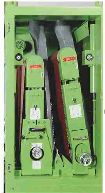
Höhenverstellbare Kontaktwalze und mechanisch gesteuerte Schleifkissenstation.
