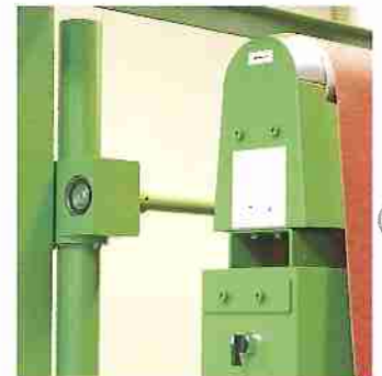
Mechanisch gesteuertes Schleifkissen, 80 mm breit. Die Spanabnahme ist über das Handrad einstellbar.
