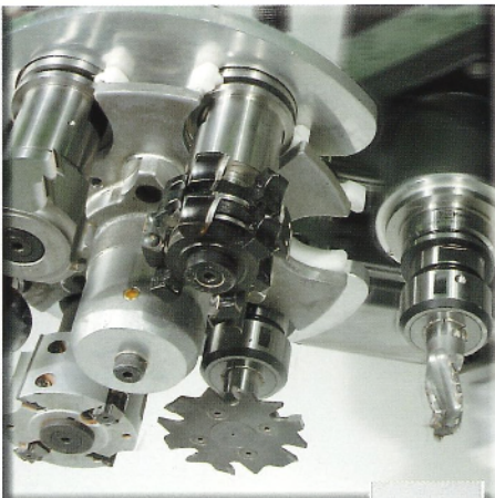
6-fach Werkzeugwechsler in X- und Y-Richtung mitfahrend
