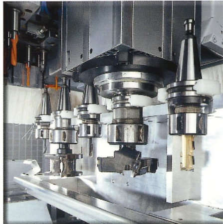
5-fach Pick-Up Werkzeugwechsler
