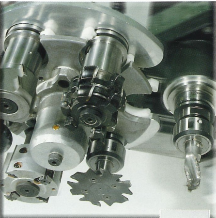
Changeur d'outils embarqué en X et Y à 6 positions
