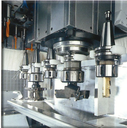
Changeur d'outils pick-up à 5 positions
