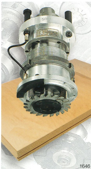
Fräsen vertikal mit getasteter Kufe
