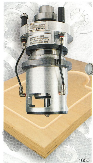
Fräsen vertikal mit getasteter Glocke
