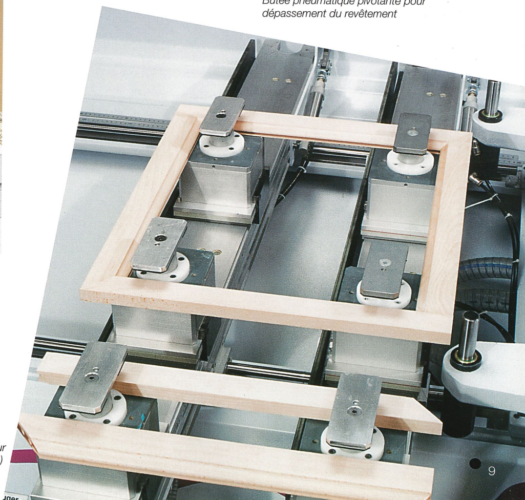
Principe de fonctionnement du système de dépression à deux circuits
