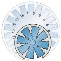
Logement d'outil sur l'avant de la machine
