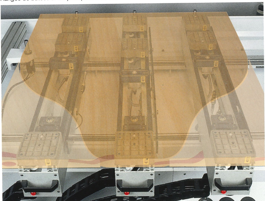
Rangée de butées arrière pour les grandes pièces
