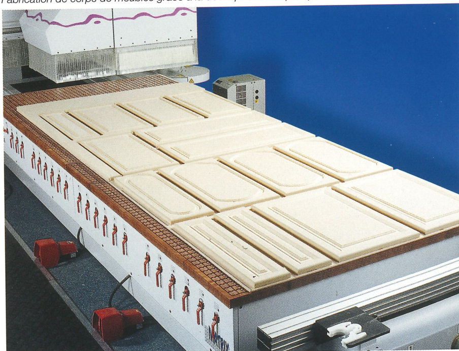
Fabrication de façades grâce à la découpe numérique optimisée
