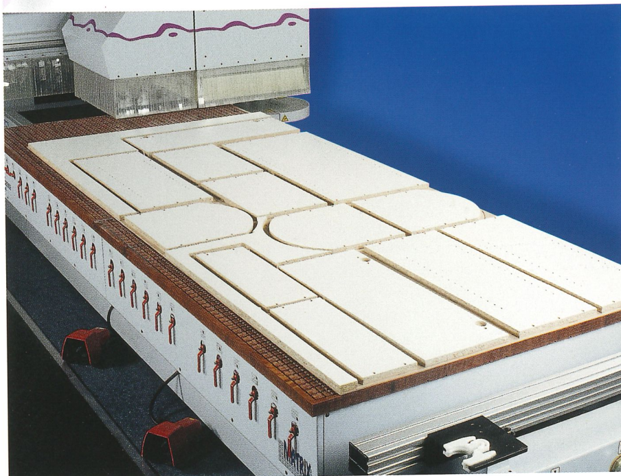
Fabrication de corps de meubles grâce à la découpe numérique optimisée
