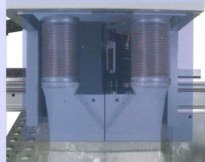
Die Bearbeitungseinheiten (Fräser oder Bohrgetriebe) werden separat abgesaugt
