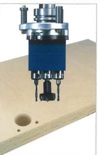
Beschlagbohr- kopf, 3 Spindeln
