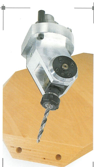
HSK 63 Bohren/Fräsen neigbar Für Bohr- und Fräsarbeiten bis zu einer Tiefe von 78 mm (0°-360°). Die Neigung des Werkzeugs kann manuell eingestellt werden (0°-90°).
