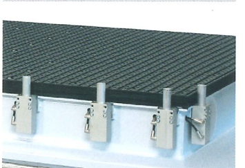
4 pneumatisch absenkbar Aluminium Anschlagzylinder (vorne rechts oder vorne links)
