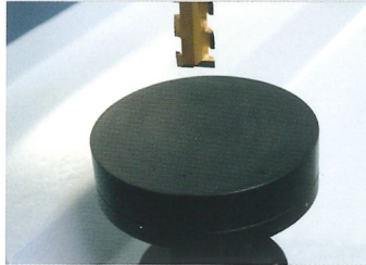
Nach einem Werkzeugwechsel wird die Länge des Werkzeuges abgefragt und mit der integrierten Werkzeugdatenbank abgeglichen
