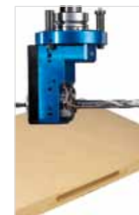
Zámková kapsa 2 vřetena, Ø 16/20 mm
