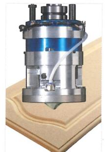
**Getastetes Fräsaggregat mit Tastring**
