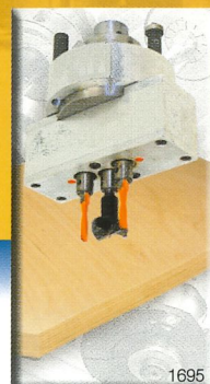
Cajeado de cerraduras con inyector de aire
