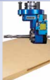
High Performance Zámková kapsa 2 vřetena, Ø 16/20 mm
