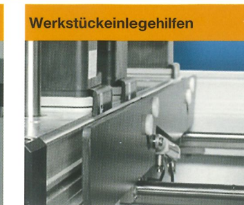
4 robuste Einlegehilfen zum Belegen schwerer Werkstücke
