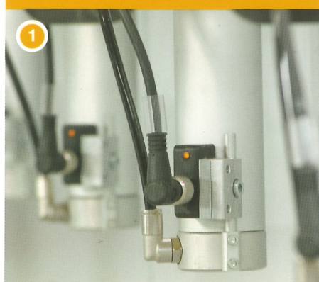
Erhöhte Sicherheit durch eine elektronische Endlagenabfrage an allen vorhandenen Anschlagzylindern
