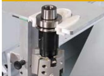
Sicheres und schnelles Beschicken des Werkzeugwechselmagazines
