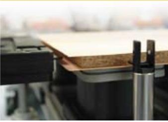
Gewährleistet einfaches Positionieren bei Material mit Furnierüberstand
