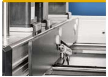
4 robuste Einlegehilfen zum Belegen schwerer Werkstücke
