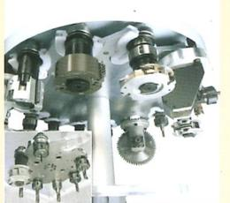
Zwei Werkzeugwechsler: 14-fach mitfahrend in X- und 8-fach mitfahrend in X- und Y-Richtung
