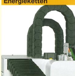
Sichere und geschützte Kabelführung (X-Y-Z)
