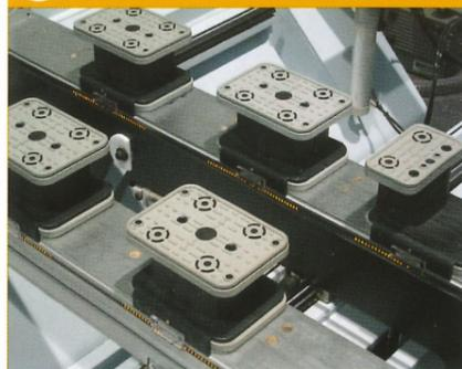
LED-Leuchten zeigen dem Bediener exakt an, wo die Sauger platziert werden müssen. Bis zu 70% schnellere Positionierung.
