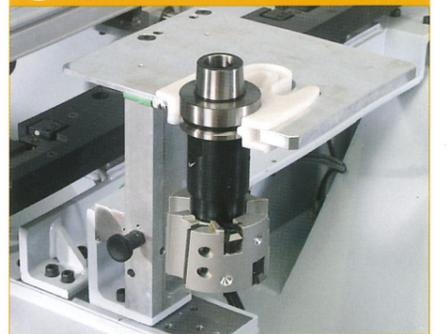
Sicheres und schnelles Beschicken des Werkzeugwechsellmagazines
