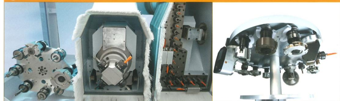
■ Mitfahrender 8-fach Werkzeugwechsler in X- und Y-Richtung ■ 25 Bohrspindeln vertikal ■ 6 Bohrspindeln horizontal
