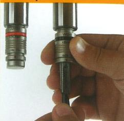
Drehzahl 1500-7500 min<sup>-1</sup> mit patentiertem Schnellwechselsystem
