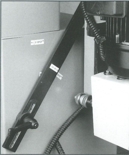
△ Schwenkvorrichtung mit Winkelgraden
