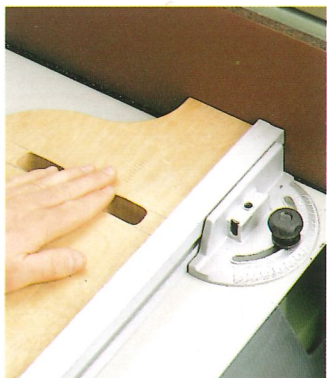
Stufenlos verstellbarer Gehrungsanschlag
