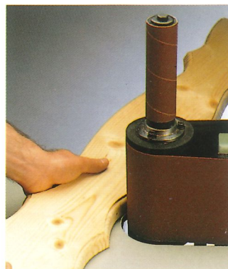
Rundsleifen an der Bandspannwalze
