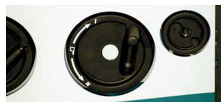
Volants pour le déplacement du guide de sciage parallèle. Grand volant pour un réglage rapide (1tour = 5,7 cm). Petit volant pour un réglage fin.
