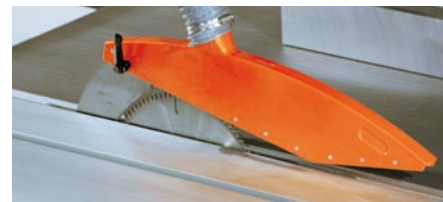
Capot protecteur fixé sur le couteau diviseur
