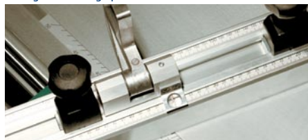
Vue détaillée du guide d'onglet, lecture par loupe, en option : double affichage digital.
