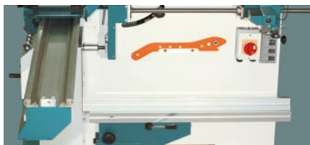
Patte d'ancrage sur châssis pour le guide de sciage parallèle
