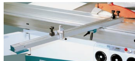
Guide d'onglet extensible compris dans l'équipement standard
