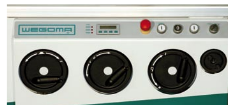
Volants de réglage sur face latérale ( de gauche à droite) hauteur de coupe, inclinaison de la lame, déplacement rapide du guide de sciage parallèle, réglage fin du guide parallèle
