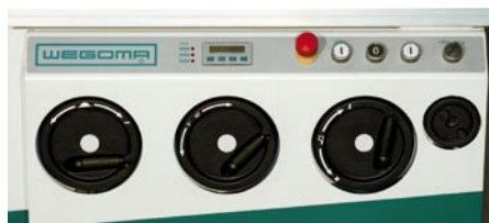
Face latérale : Volants pour le réglage de la hauteur, de l'angle et du guide de sciage parallèle
