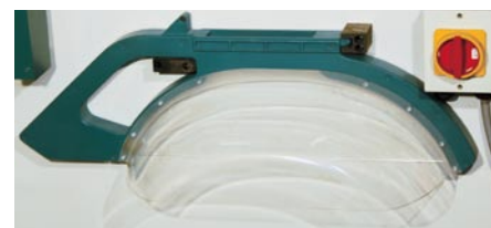
Logement pour capot de protection
