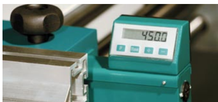
Guide de sciage parallèle à affichage digital
