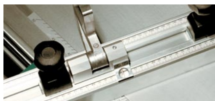
Guide d'onglet (lecture par loupe) en option : double affichage digital
