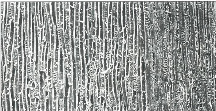
Hydrogehobelte Oberflächen weisen die niedrigsten Rauheitswerte auf, im unbehandelten wie im grundierten Zustand.
