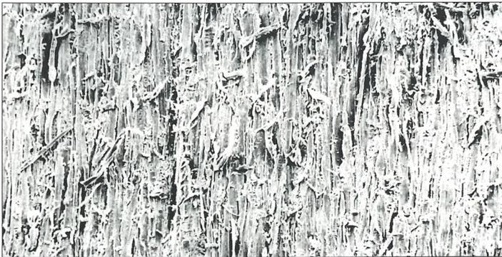
Dies hat zur Folge, daß die Fasern bei der Oberflächenbehandlung mit Wasserlacken quellen und sich aufrichten. Damit zugleich nimmt die Rauheit der Oberfläche zu.
