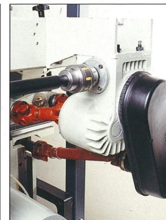
Antrieb durch Kardan-gelenke: robuster, wartungsfrei, langlebiger, präziser.
