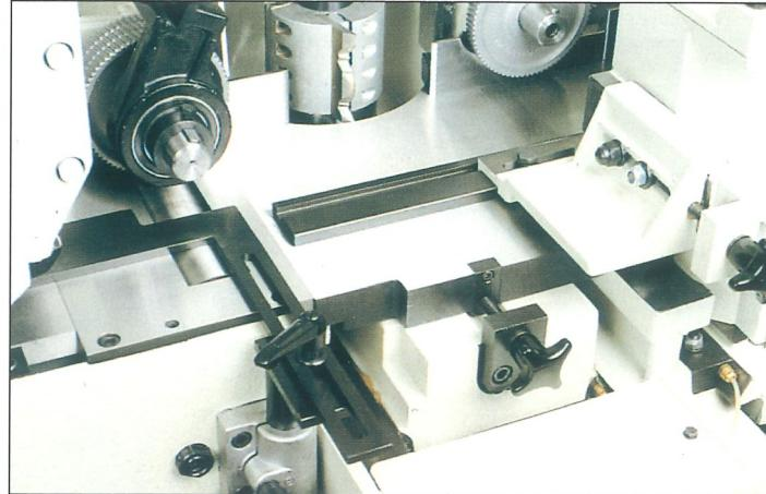
Быстро переставляемый вкладыш плиты стола. Благодаря дублирующим элементам плиты стола увеличивается износостойкость шпиндельной задвижки.
