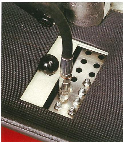
Zentrale Position der Schmierstellen dadurch geringer Wartungsaufwand. Sie vergessen keine Schmierstellen, auch die der axialen Spindelver- stellungen nicht.
