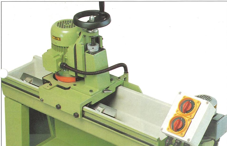
Hobelmesser-Schleifmaschine R 45. Hält die Messer scharf. Bis 650 mm Schleiflänge. Bis zu 4 Hobelmesser gleichzeitig schleifen. Motorischer Schleifvorschub. Automatische Schleifscheibenzustellung. Integrierte Naßscheiben-Einrichtung.
