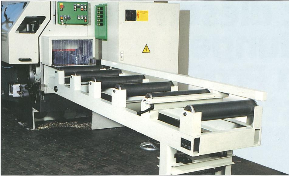
Schwere Rollenbahn. Ist mit dem Profimat 45 fest verbunden. An Ein- und Auslauf. Wurde für extrem schwere Werkstücke konstruiert. Auch mit Gabelstapler zu beschicken. Höhenverstellbar entsprechend Spahnabnahme.
