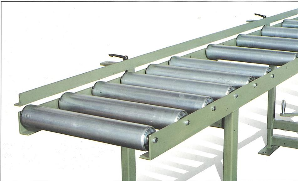
Standard-Rollenbahn. Fest mit dem Profimat 45 verbunden. Leicht einzustellen. Für Werkstücke leichter und mittlerer Gewichtsklassen gebaut. Höhenverstellbar entsprechend Spahnabnahme.
