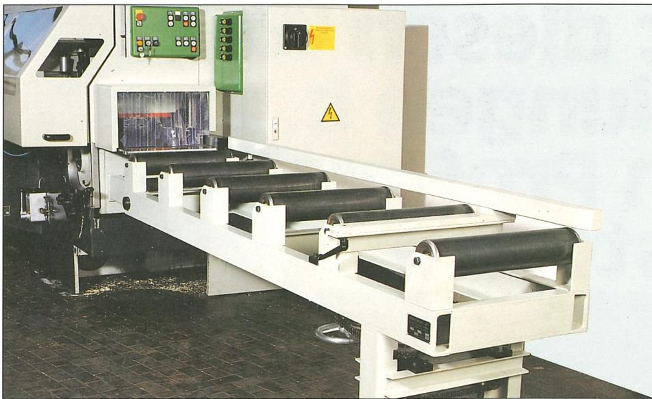
Schwere Rollenbahn. Ist mit dem Profimat 45 fest verbunden. An Ein- und Auslauf. Wurde für extrem schwere Werkstücke konstruiert. Auch mit Gabelstapler zu beschicken. Höhenverstellbar entsprechend Spanabnahme.
