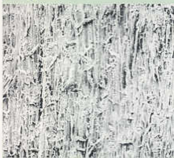
Rasterelektronenmikroskop-Aufnahme: Werkstückoberfläche geschliffen
