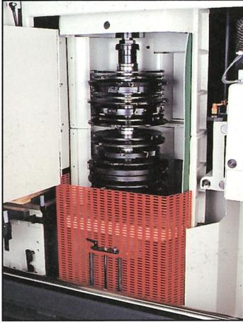
Die Zapf- und Schlitzspindel nimmt acht Werkzeuge auf. Kein Werkzeugwechsel. Das Vierfachkonter ermöglicht Ihnen ein absolut ausrißfreies Schlitzen aller acht Profile. Ohne Wechsel!
