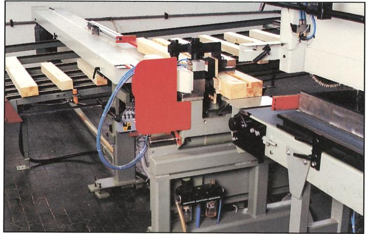
Elektronischer Längenanschlag mit Laser-Richtlicht! Die elektronisch gesteuerte Säge stellt sich automatisch auf unterschiedliche Zapfenlängen ein.
