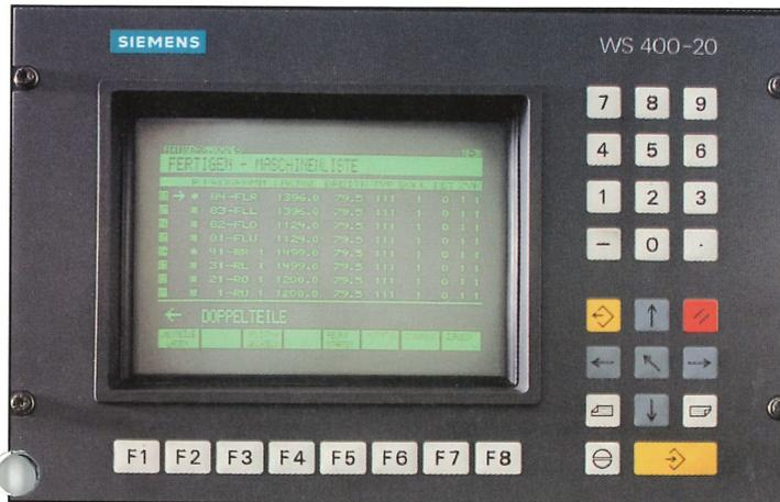
Mit der Programmsteuerung arbeitet die Unicontrol 10 völlig automatisch. Die Arbeitsabläufe programmieren Sie im Dialog mit dem Bildschirm. Hier sehen Sie die rahmenweise Fertigung von Fenstern – mit Doppelteilepaket.
