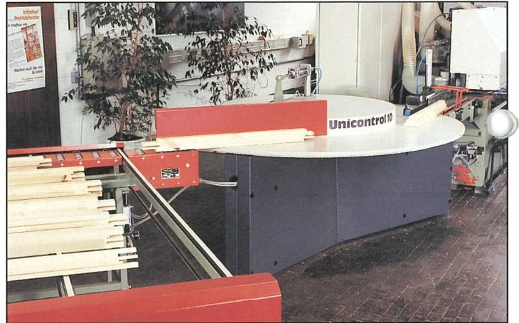
Vom Wender werden die Teile automatisch zur Rahmenpresse transportiert.
