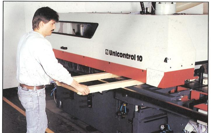
Das Umfräsen der verleimten Fensterflügel sichert absolute Präzision.
