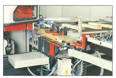
Elektronischer Längenanschlag. Auf dem Schlitztisch mitfahrend bis 3600 mm Holzlänge für Schrägfensterfertigung oder feststehend bis 4500 mm. Die elektronisch gesteuerte Säge stellt sich automatisch auf unterschiedliche Zapfenlängen ein.
