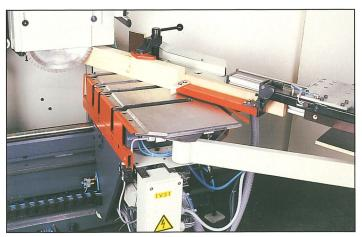
Schrägfenster: Manuelle Winkeleinstellung  $\pm\,60^\circ$  Synchronisation Soll/Ist über Bildschirmanzeige. On-line-Fertigung mit automatischer Längenpositionierung des elektronischen Längenanschlags. Optimale Konterung durch Nachführleiste. Motorischer Tischvorschub, rebelbar am Bedienpult.
