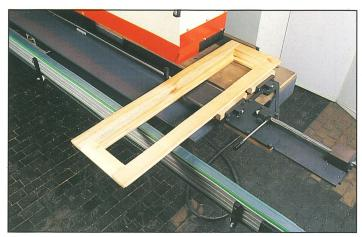
Das Umfräsen der verleimten Fensterflügel garantiert absolute Präzision. Ein mitlaufeder Gleitriemen sichert einen optimalen Transport. Kleine Flügel können in einen Umfräswagen gespannt werden.
