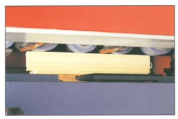
Mit der Weinig Unicontrol 10 können Sie selbst schmale, nur 220 mm (lichtes Maß) lange Werkstücke bearbeiten. 21 Vorschubrollen sorgen für einen sicheren Transport.
