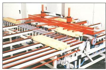
Ein Mann genügt! Die automatische Wendevorrichtung erspart das manuelle Wenden der Werkstücke am Zapfenschläger. Werkstücke mit linkem und rechtem Profil werden ohne Zeitverlust profiliert, ohne daß Sie dazu eine linke Spindel brauchen.
