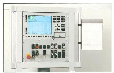
Die PC Steuerung. Am Farbbildschirm kontrollieren Sie die Daten Ihres Fensterprogrammes, legen die Arbeitsabläufe fest. Sicher geführt im Dialogmodus. Einfach, schnell und komfortabel dank grafischer Bedienoberfläche. Proflie, Werkzeuge, Teileverfolgung. Die Anzahl der abspeicherbaren Werkzeugbelegungen ist unbegrenzt!
