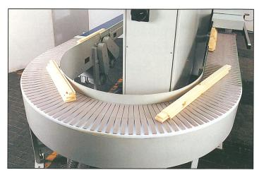
Durch das automatische Wendesystem kommen die Teile gewendet zum Bediener zurück. Fertige Teile können durch einen Ausweiser automatisch an die Rahmenpresse transportiert werden.
