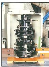
Bis vier Werkzeugsätze nimmt die Mehrfach-Hubspindel zum Längsprofilieren auf. Kompakt dazu angeordnet ist die getaktete Glasleistensäge mit Spaltkeil-Abführung und Fräseinheit für die Beschlagnut.
