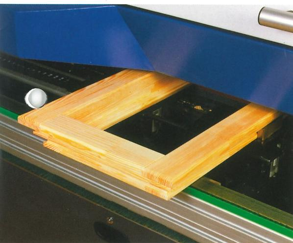
Durch das automatische Wendesystem kommen die Teile zum Bediener zurück. Fertige Teile können durch einen Ausweiser auf ein Fördersystem und anschließend automatisch an die Rahmenpresse transportiert werden.
