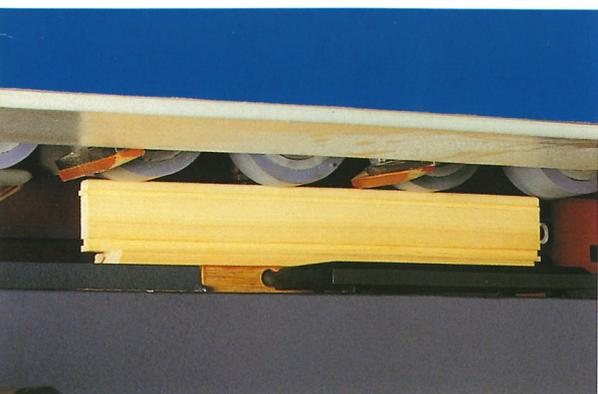
Mit der Weinig Unicontrol 10 können Sie selbst schmale und kurze Werkstücke bearbeiten. Der Abstand (110 mm) der Vorschubrollen sowie das Weinig-Kurzteilpaket sorgen für einen sicheren Transport durch die Maschine.
