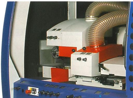
Leicht zugänglich, schnell in der Bedienung: Die Zentralverstellungen der Druckorgane und Führungen.
