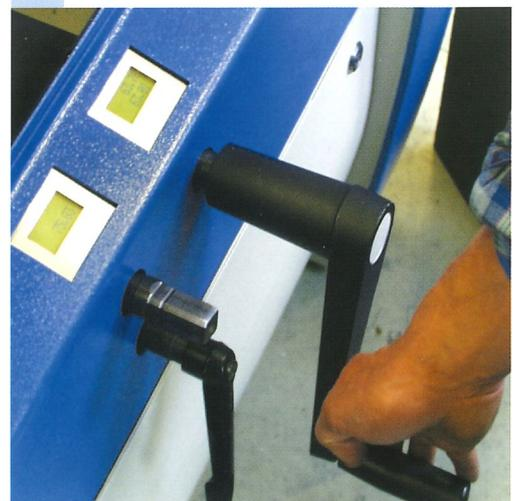
Die Werte werden an den Einstellpunkten angezeigt. Mit der Handkurbel wird die Einstellposition so lange verstellt, bis die Zielposition erreicht ist.
