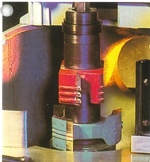
Bis zu 80 mm Axialverstellung der Vertikalspindel. Das heißt, bessere Werkzeugnutzung und geringe Rüstzeiten.
