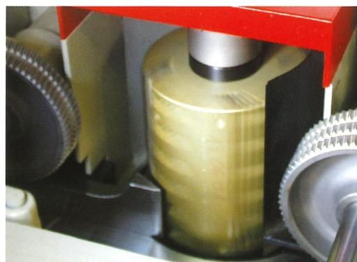
Die hohe Drehzahl der Arbeitsspindel sorgt für eine hervorragende Oberflächenqualität bei günstiger Schnittgeschwindigkeit.
