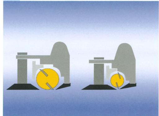
Automatische Anpassung des Spanraums an den jeweiligen Werkzeugdurchmesser. Das sorgt für günstigsten Späneflug.
