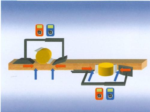
Sie lassen sich gemeinsam schnell und einfach über eine Verstellachse auf die jeweiligen Werkzeuge einstellen. Die Achsen sind mit elektronischen Digitalanzeigen ausgerüstet und im „Memory“ integriert.
