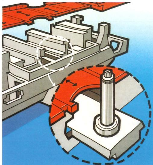
Die Tischplatten sind leicht auswechselbar und auf den Werkzeug-Flugkreis der Vertikalspindel einstellbar.
