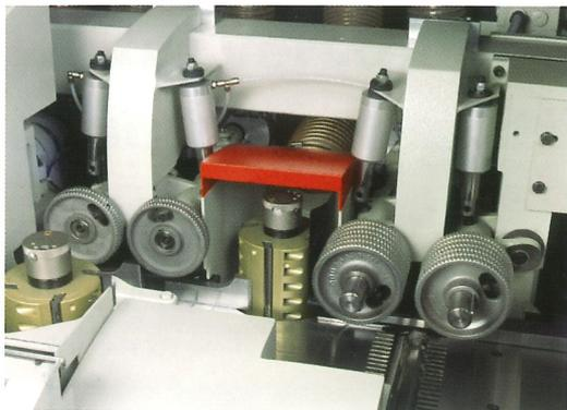
Der massive Maschinenvorschub wird mittels zweier Präzisionsträger motorisch hoch-tief bewegt.
