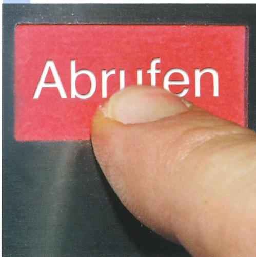
*Quando l'operatore vuole produrre il profilo memorizzato richiama i valori di messa a punto tramite pulsante.*
