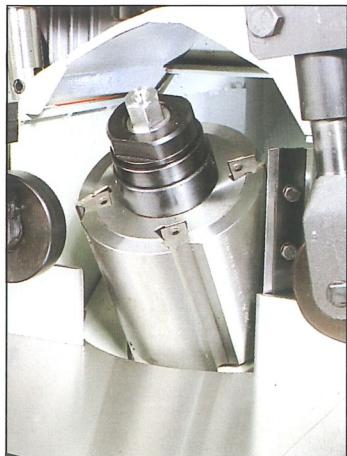
Вы можете приобрести Унимат с наклоняемым правым шпинделем! С ним можно выполнять сложные профили. При наклоне возможны малые окружности резания. Улучшается качество поверхностей.
