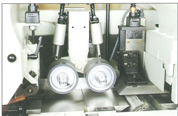
Благодаря точному прохождению заготовок относительно верхнего и нижнего шпинделей обеспечивается безупречное качество поверхности и абсолютная параллельность пластей. Приводные вальцы на выходе станка располагаются над столом и в самом столе, обеспечивая гарантированный выход из станка деталей любой толщины.
