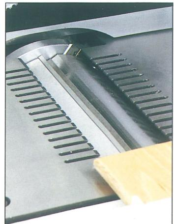
Люковые прижимные ролики обеспечивают надежное прохождение даже коротких и узких заготовок.
